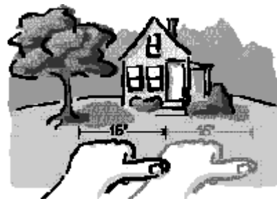
Abb. GPS-L-8: Abmessung von 15°-Schritten mit der Hand
