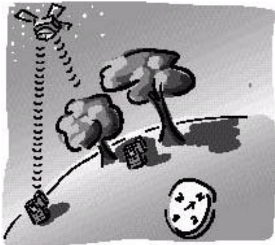
Abb. GPS-P-5: Freie und behinderte Sicht auf den GPS-Satelliten
